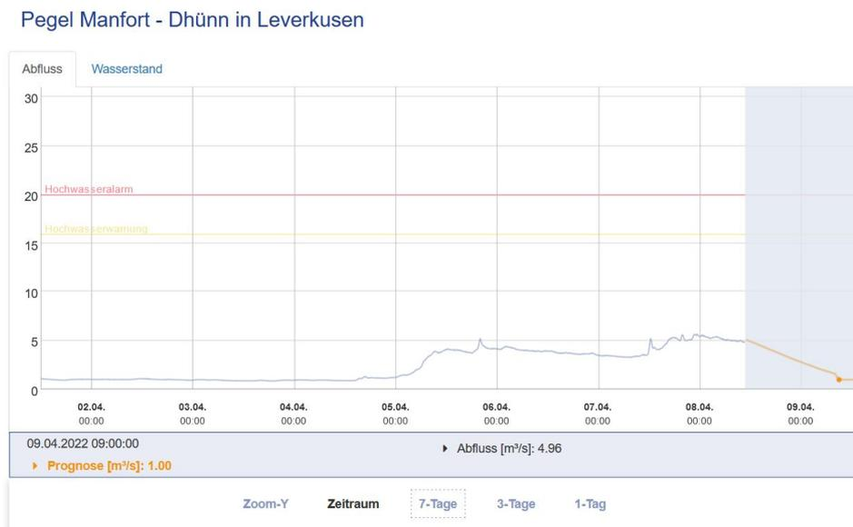
Abbildung 3: Darstellung des aktuellen Abfluss und der Prognose für den Pegel Manfort
