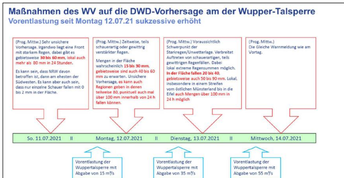
Abb. 13: Vorentlastungsschritte der Wupper-Talsperre vom 12.-14. Juli 2021 (Wupperverband, 2021)
